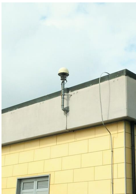
Figura 3. Esempi di installazioni di antenne GNSS in reti non geofisiche. A sinistra è rappresentata la monumentazione geodetica della stazione MINE (Minerbio) della Stogit e a destra della stazione GUAS (Guastalla), della Rete di Stazioni Permanenti GNSS della Fondazione Geometri e Geometri Laureati dell'Emilia Romagna ( http://www.gpsemiliaromagna.it ).
