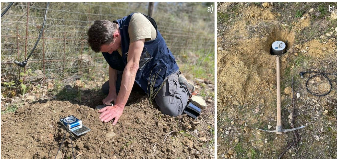
Figura 2.10. (a) Installazione del sismometro presso uno dei siti dell'array MALA (man at work). Orientamento del sensore sismico in direzione N-S.
